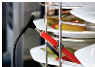
Para Finishing® com a bandeja de pratos, insira a sonda de núcleo no tubo de cerâmica na bandeja de pratos móvel.
