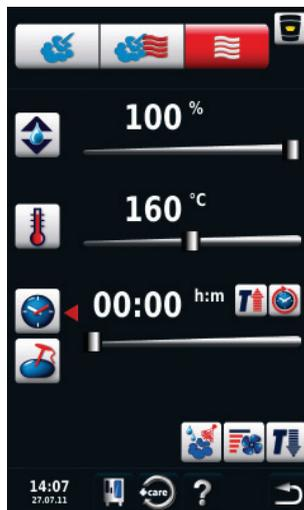
Você entra no modo **combi-steamer** pressionando o botão “vapor”, “combinação” ou “calor seco”. Veja a seção modo Combi-steamer para uma descrição.
