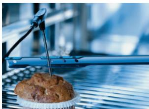
Use o suporte de posicionamento caso a sonda de núcleo possa cair do alimento (por exemplo, se o alimento for de consistência mole ou não é muito espesso).
